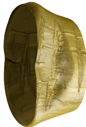
Zdeformowana powierzchnia pocisku
